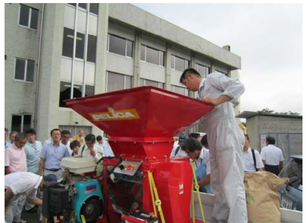
飼料用米破砕機 「籾」と「玄米」の両方の破砕を実演しました
